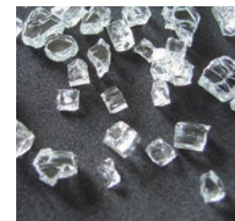
強化ガラスの破損
